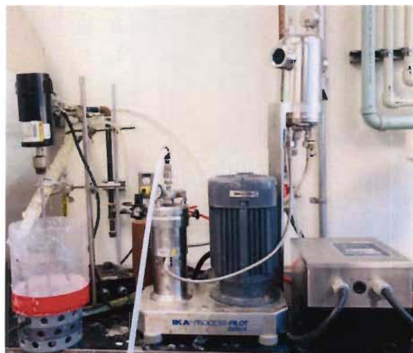
Figure 3.4 Système de traitement mécanique des fibres de cellulose oxydées TEMPO en utilisant un homogénéisateur IKA
