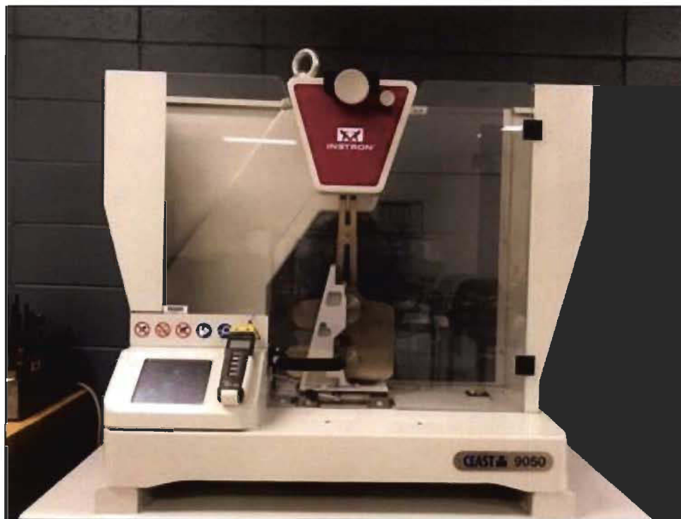
Figure III-6 Machine de Charpy mouton pendule CEAST 9050 utilisée dans les tests
