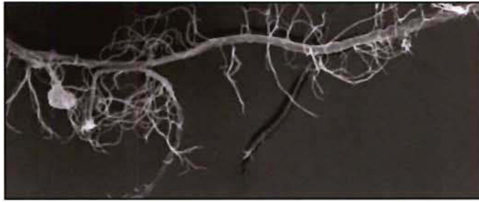
Figure II-8 Kevlar grossi 200 X au microscope électronique [30]
