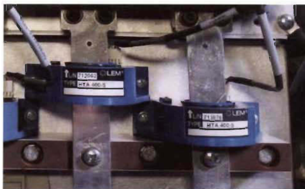
Figure 4-5 Capteurs de courant installés sur chacune des branches [33]
