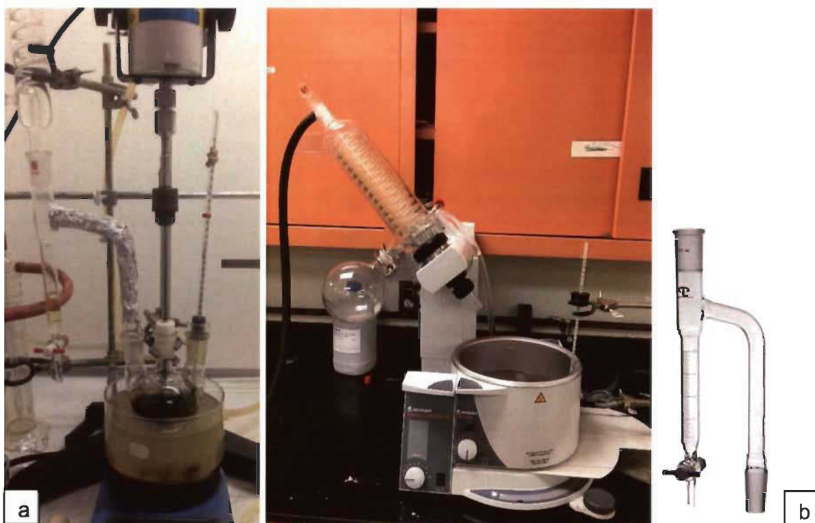
Figure 16 a) Photo du montage utilisé pour l'estérification des huiles en laboratoire b) photo d'un Dean-Stark
