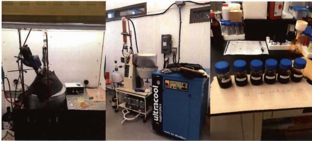
Figure 17 Montage utilisé pour l'estérification des huiles, évaporateur rotatif et tubes scellés utilisés pour l'étude de vieillissement
