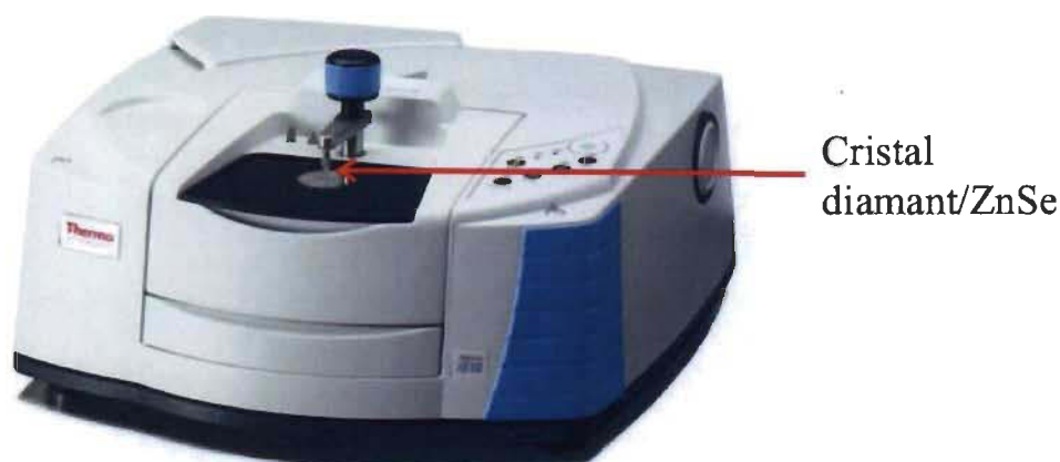
Figure 4.11 : Spectromètre Nicolet IS10™ de ThermoScientific™ équipé d'un cristal diamant/ZnSe [148].
