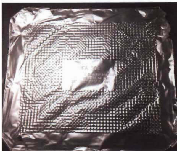
Figure 7.1 : Film de nanocellulose grand format pour les vitres 30 x 30 cm 2 .
