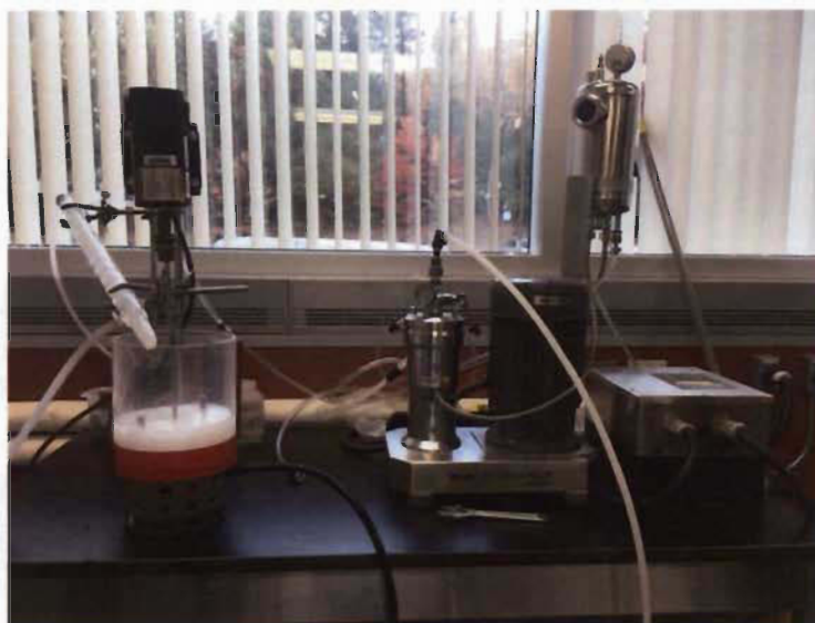
Figure 4.3 : Procédé de séparation des fibres oxydées par l'appareil IKA™.
