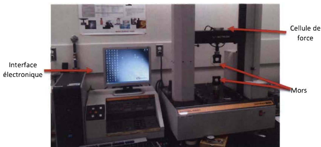
Figure 4.14 : Essai de traction sur un Instron™ 4201 et son logiciel Blue Hill™.
