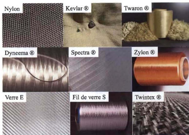
Figure 7.8 : Types de produits pour les protections balistiques individuelles.
