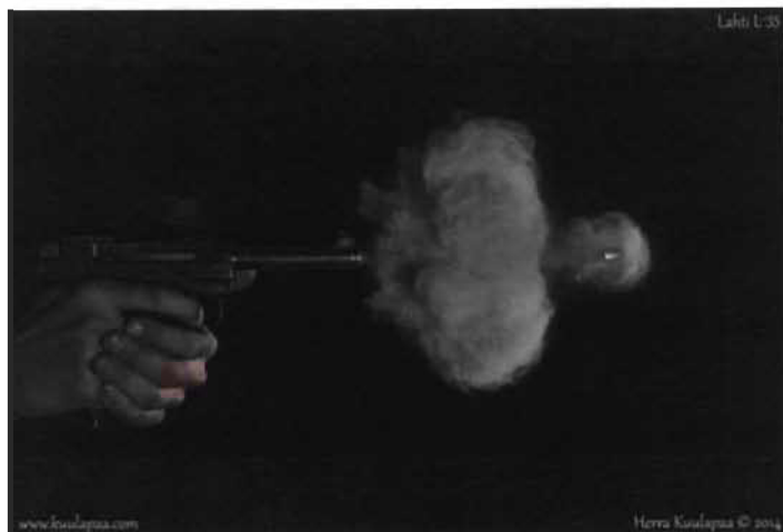
Figure 7.5 : Comportement des gaz lors de la sortie d'un projectile [164].
