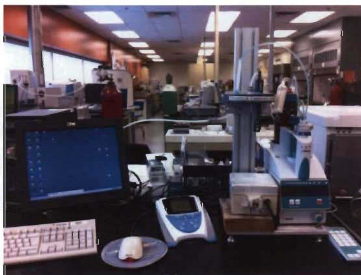
Figure 4.5 : Conductimètre de Thermo Orion™, modèle 150, avec une pompe auto doseuse automatique de Birkmann™, modèle Metrohm™, couplés à un ordinateur.
