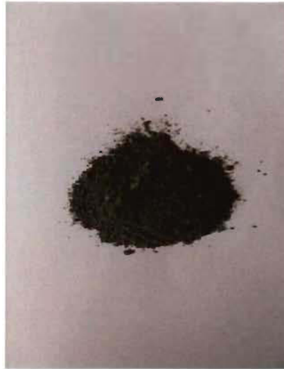
Figure 3. 5 : image de la poudre de SnO2 utilisé
