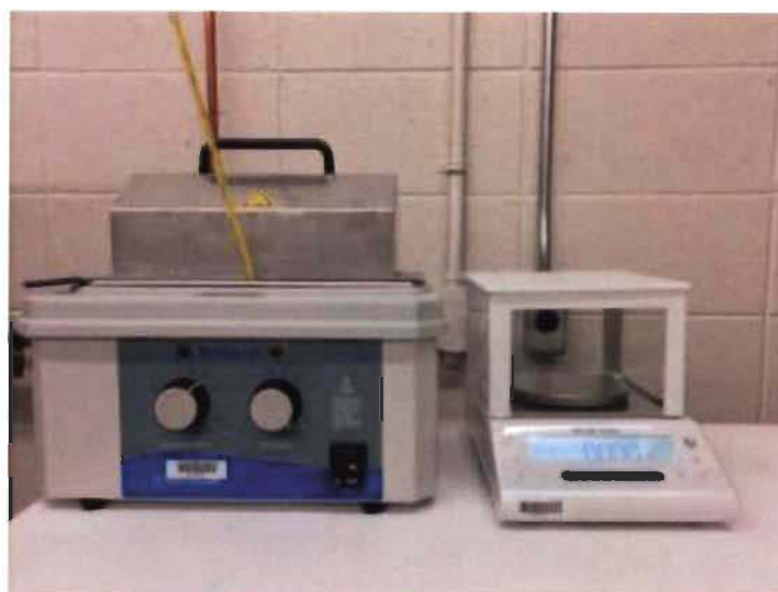
Figure V.3. Bain hydrothermal (Isotemp) avec la balance de précision
