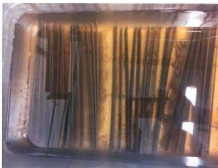
Figure V.8. Échantillons FEH vieillis dans le bain thermal
