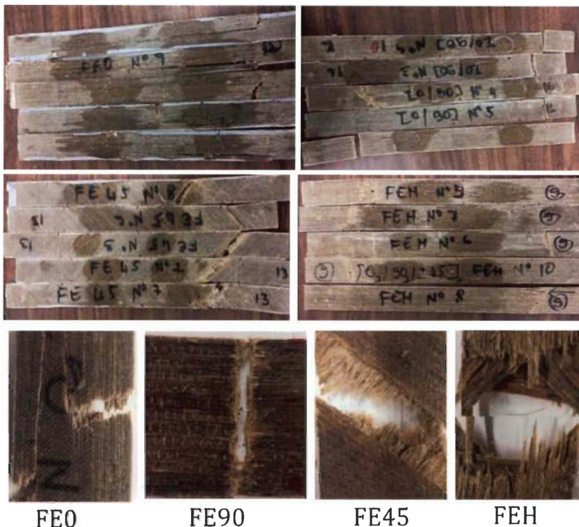
Figure IV.10. Faciès de rupture des échantillons FE0, FE90, FE45 et FEH après les essais de traction
