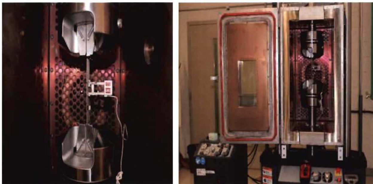
Figure V.4. Dispositif d'essai de traction avec la machine MTS 809 dans une chambre environnementale couplé avec un extensomètre et un thermocouple
