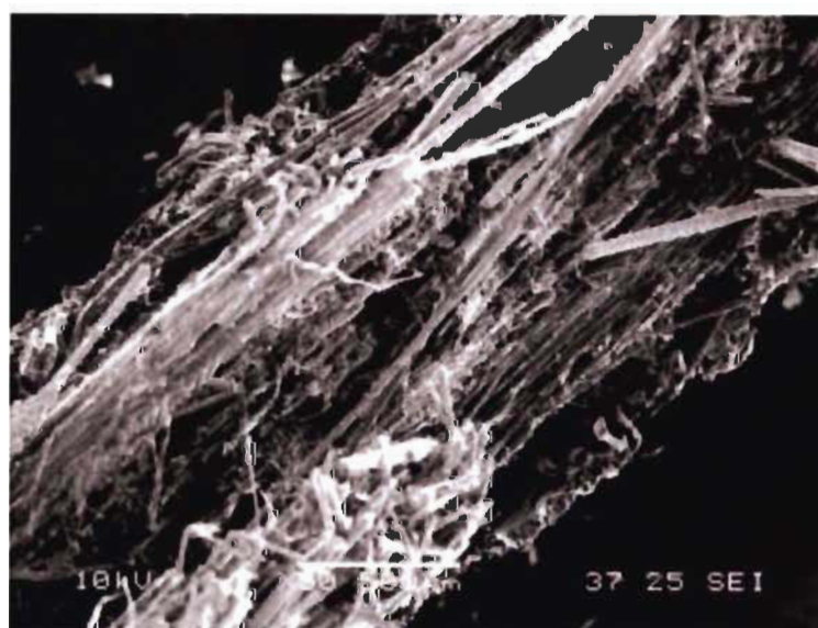
Figure VI.22. Image MEB du faciès de rupture d'une éprouvette FEH après un essai de fatigue
