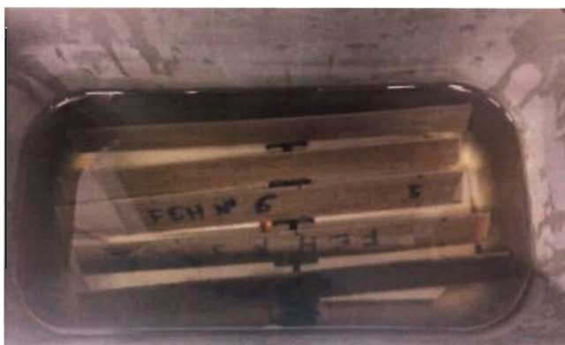
Figure V.2. Échantillon FEH immergée dans de l'eau distillée
