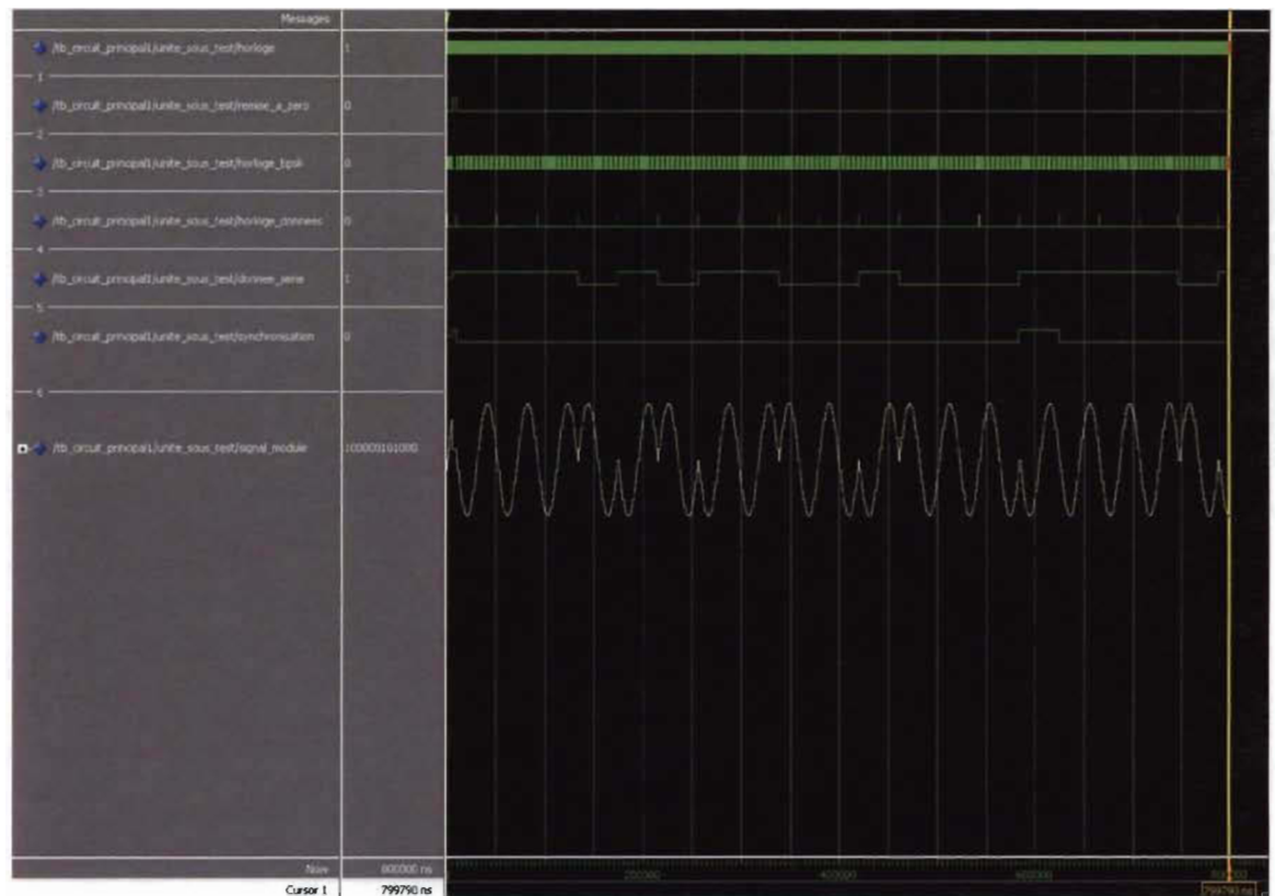
Figure D.22 : Résultats obtenus du modulateur BPSK
