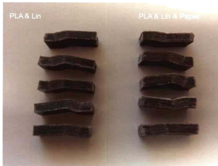
Figure 38: Éprouvettes courtes après essais de flexion
