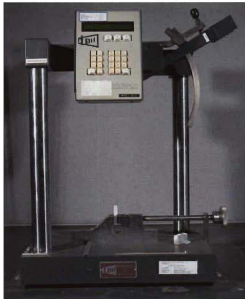
Figure 19: Machine d'impact TMI ( www.testingmachines.com )
