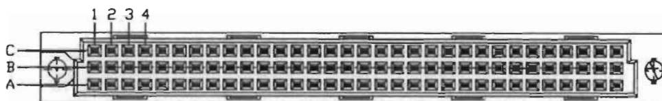
Figure C-1 Configuration des pins pour le connecteur DIN.
