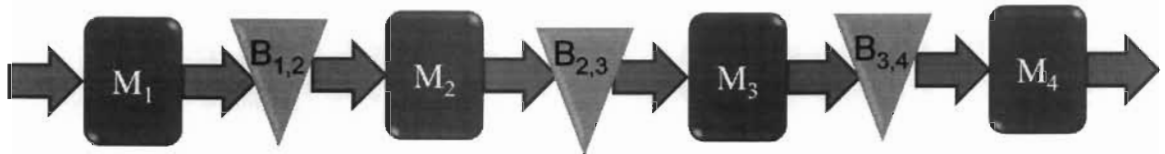
Figure 4.7 – Quatre machines en série séparées par trois stocks tampons
