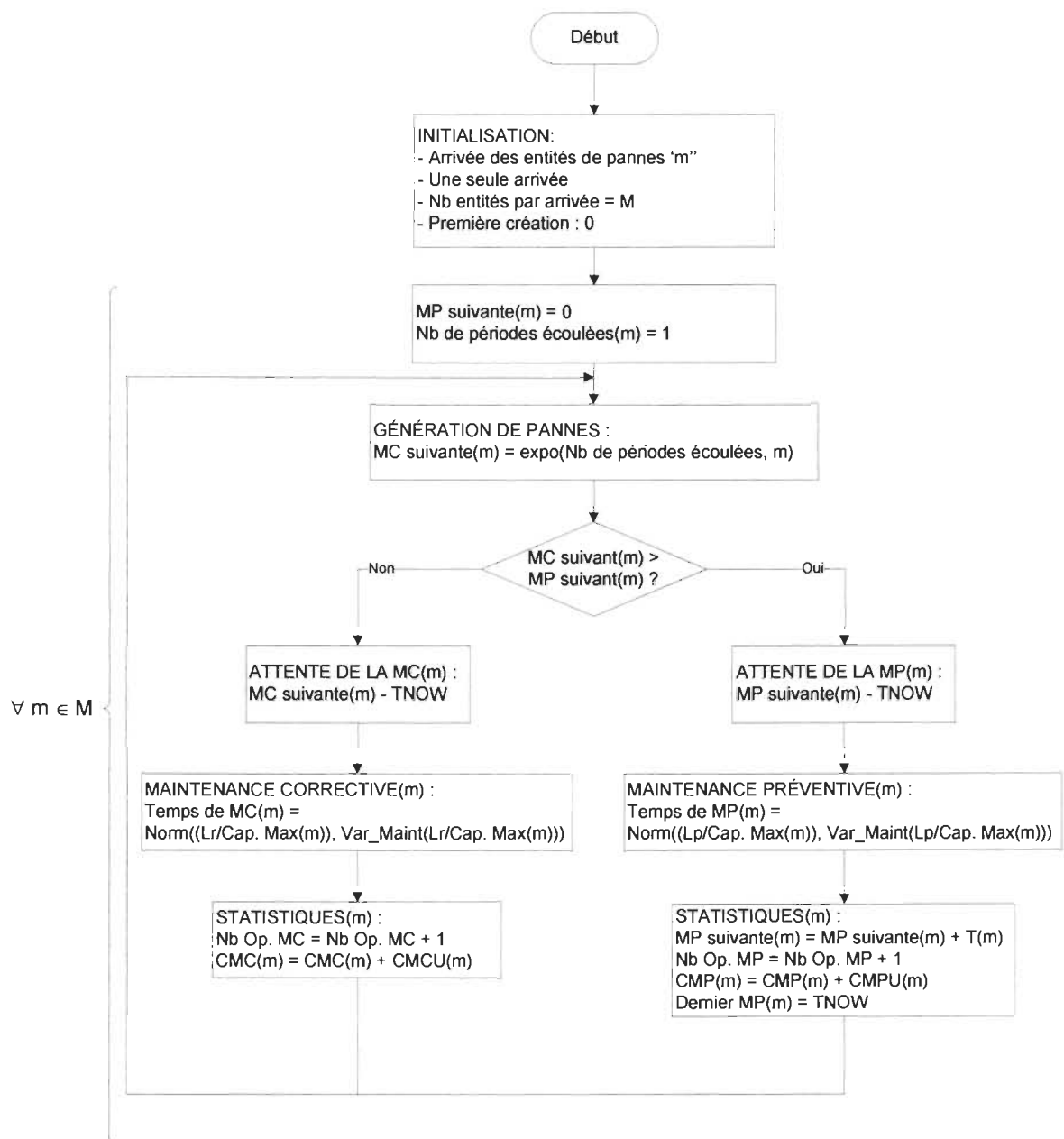
Figure 4.5 – Ordinogramme représentant la défaillance et la maintenance des machines pour un remplacement indépendant de type bloc
