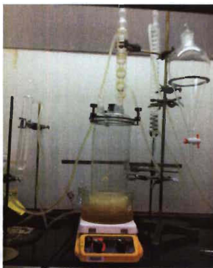
Figure 4.3 Schéma du montage expérimental de la modification de la pâte kraft
