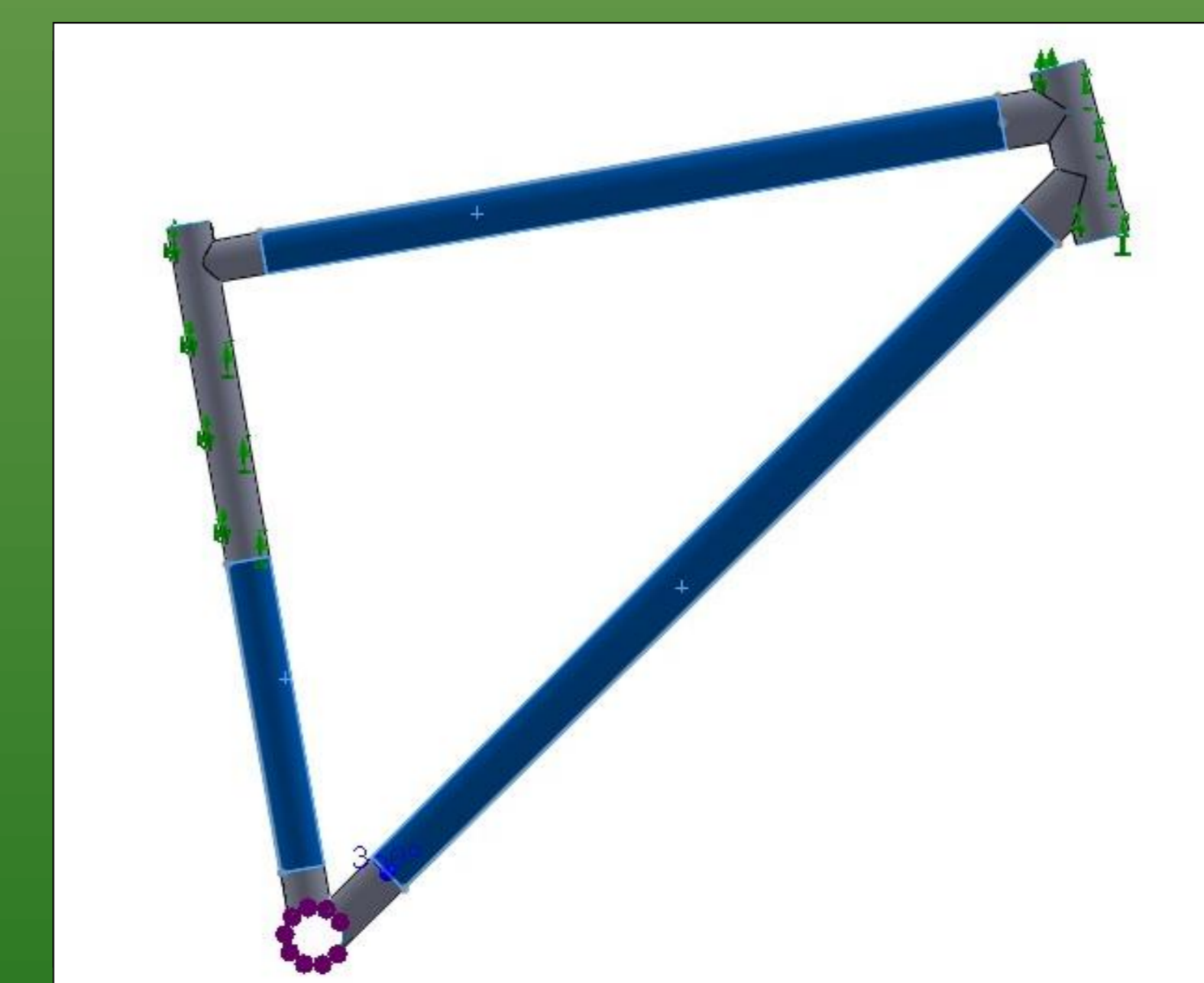
Figure 6 Triangle avant d'un cadre de vélo modélisé dans le logiciel SolidWorks (zones de design en bleu et zones de non design en gris)
