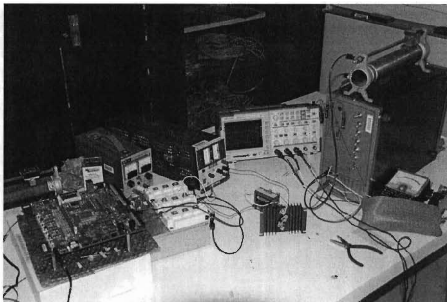
Figure 3.25: Photographie du prototype de commande rapprochée Posicast : on distingue à gauche, la carte de développement FPGA et le circuit de conditionnement et à droite le montage abaisseur de puissance et l'instrumentation.
