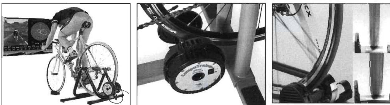
Figure 2.3 : Dynamo électromagnétique (Racermate, Computrainer Lab, Seattle, WA, USA) et pneu Tacx (T1390).
