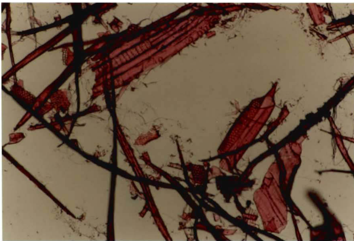
Figure 4.41 Photomicrographie de la pâte BCTMP non raffinée [104X].
