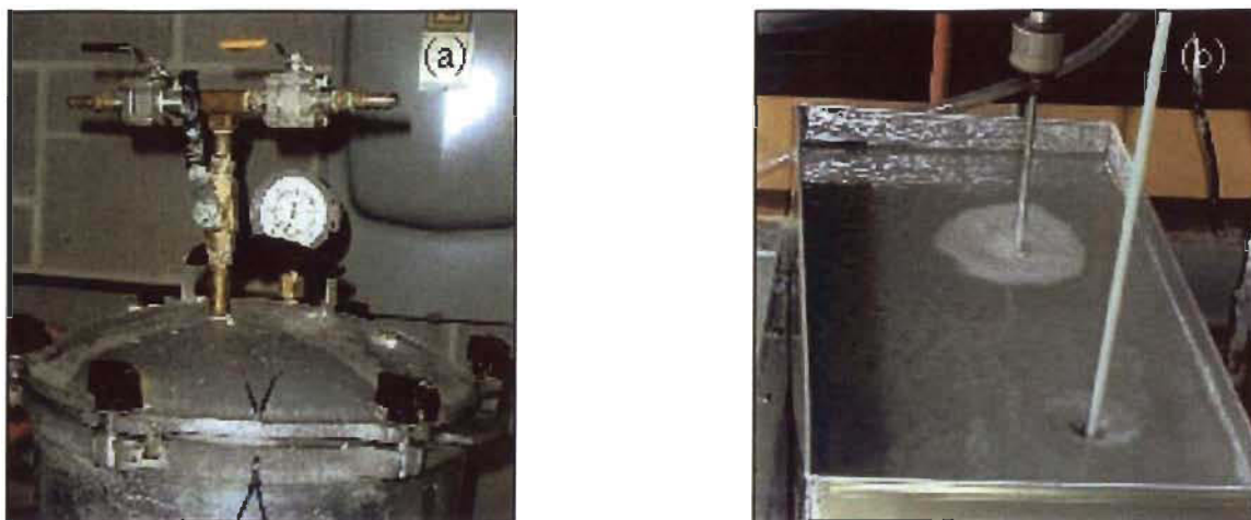
FIGURE 4.4 (a) Réservoir auxiliaire de vide, (b) cuve de formation.
