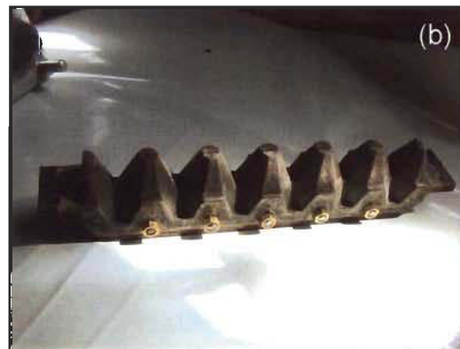
FIGURE 4.7 (a) Décollage d'une caissette, (b) support utilisé pour le transport et le séchage.
