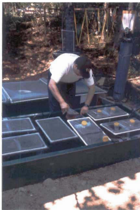
Figure 5. Système d'aquariums utilisé sur le terrain lors d'un essai biologique. À noter en arrière plan, la bonbonne d'air comprimé qui alimentait les bacs d'intoxication et de récupération.
