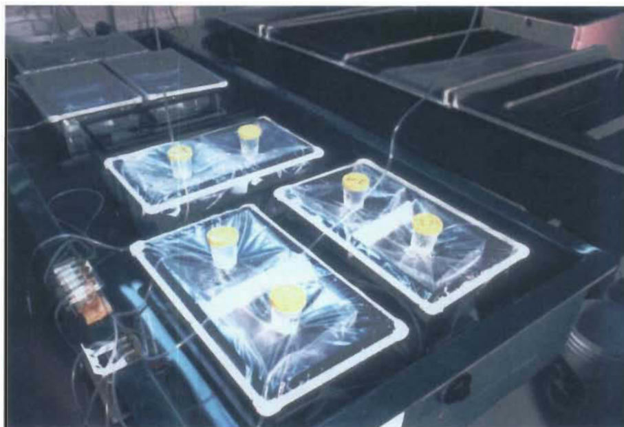
Figure 1. Système expérimental utilisé en laboratoire, constitué d'une série d'aquariums immergés dans un bassin où circulait de l'eau tempérée.
