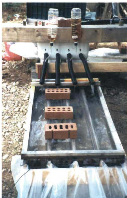
Figure 8. Système de gouttières utilisé lors d'un essai biologique. À noter la présence de bouteilles de type Mariotte.
