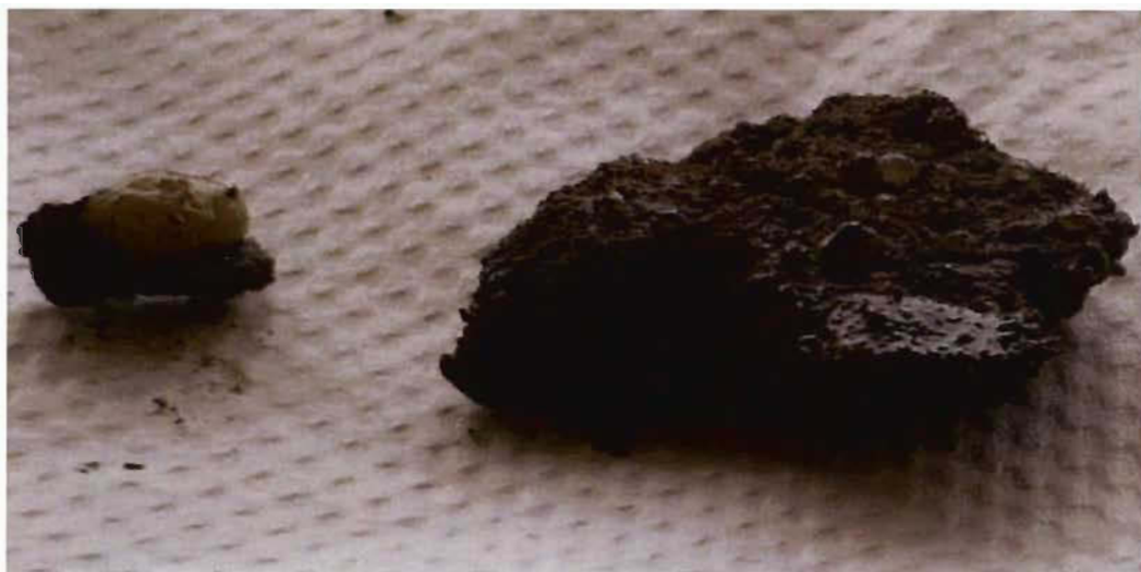
Figure 4.40 : Résidus solides présent dans le réacteur à la fin de la réaction de la Manipulation 13.
