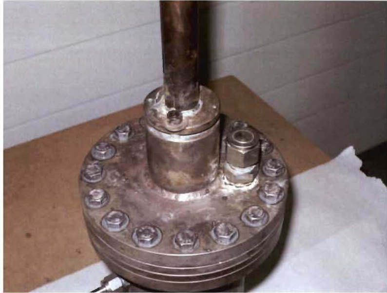
Figure 3.7 : Modification de la boîte d'étanchéité et installation d'un orifice d'insertion des réactifs.
