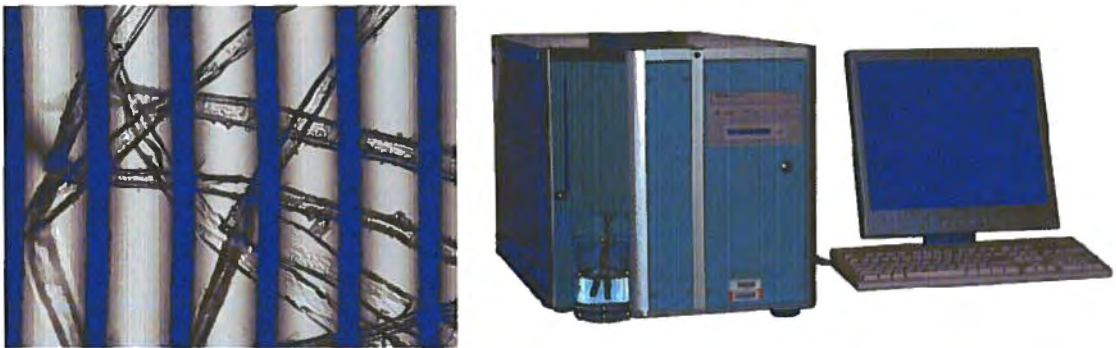
Figure 4.7 Image de fibres (à gauche) d'une pâte thermomécanique prise par l'appareil MWT (à droite) pour la mesure d'épaisseur de paroi par analyse d'image
