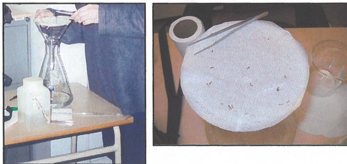
FIGURE 10 : Système de rinçage des tubes et de récupération des larves.
