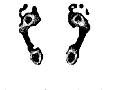
Figure 5. Image de la pression exercée sous les pieds mesurée par le tapis de pression Matscan.
