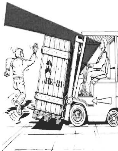
Figure 3.5 : L'angle mort lors d'un déplacement en marche avant [12]
