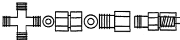
Figure 11 Détails du porte-échantillon du système volumétrique (0-1) bar.
