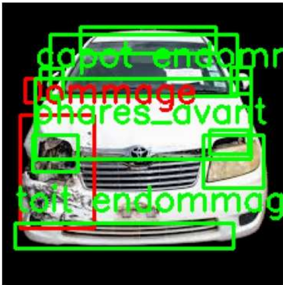
Figure 5 : Sortie brute des détecteurs de pièces et de dommages — vert : pièces ; rouge : dommages.
