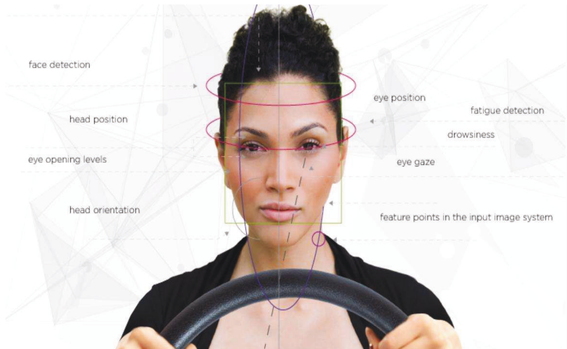
Figure 2.6 : Illustration de la détection et de l'analyse des repères faciaux par traitement d'images [82].
