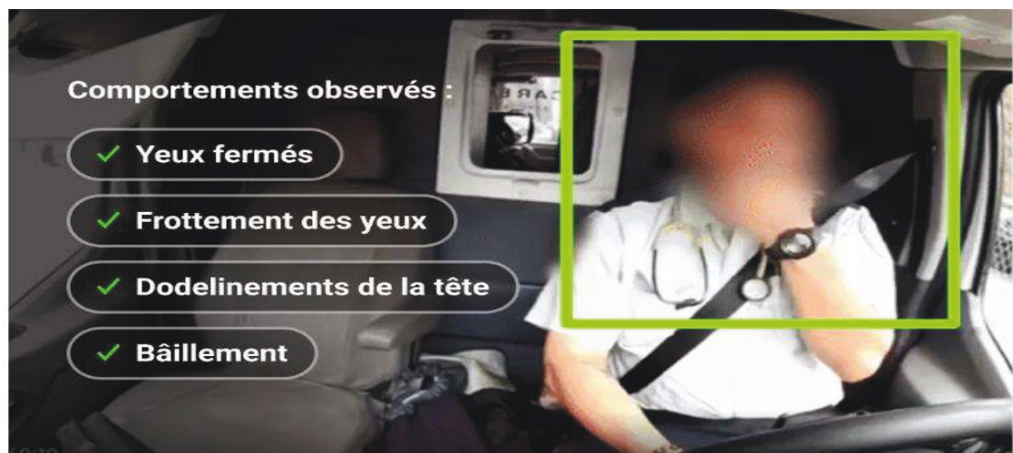
Figure 2.9 : Surveillance du visage du conducteur par techniques de traitement d'images [97].
