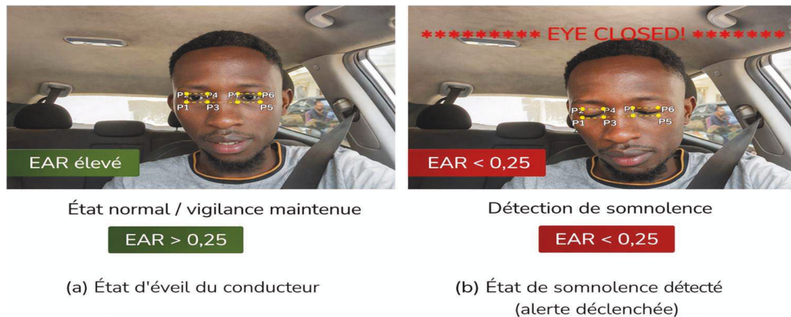
Figure 4.14 : Situation d'ouverture et de fermeture des yeux.
