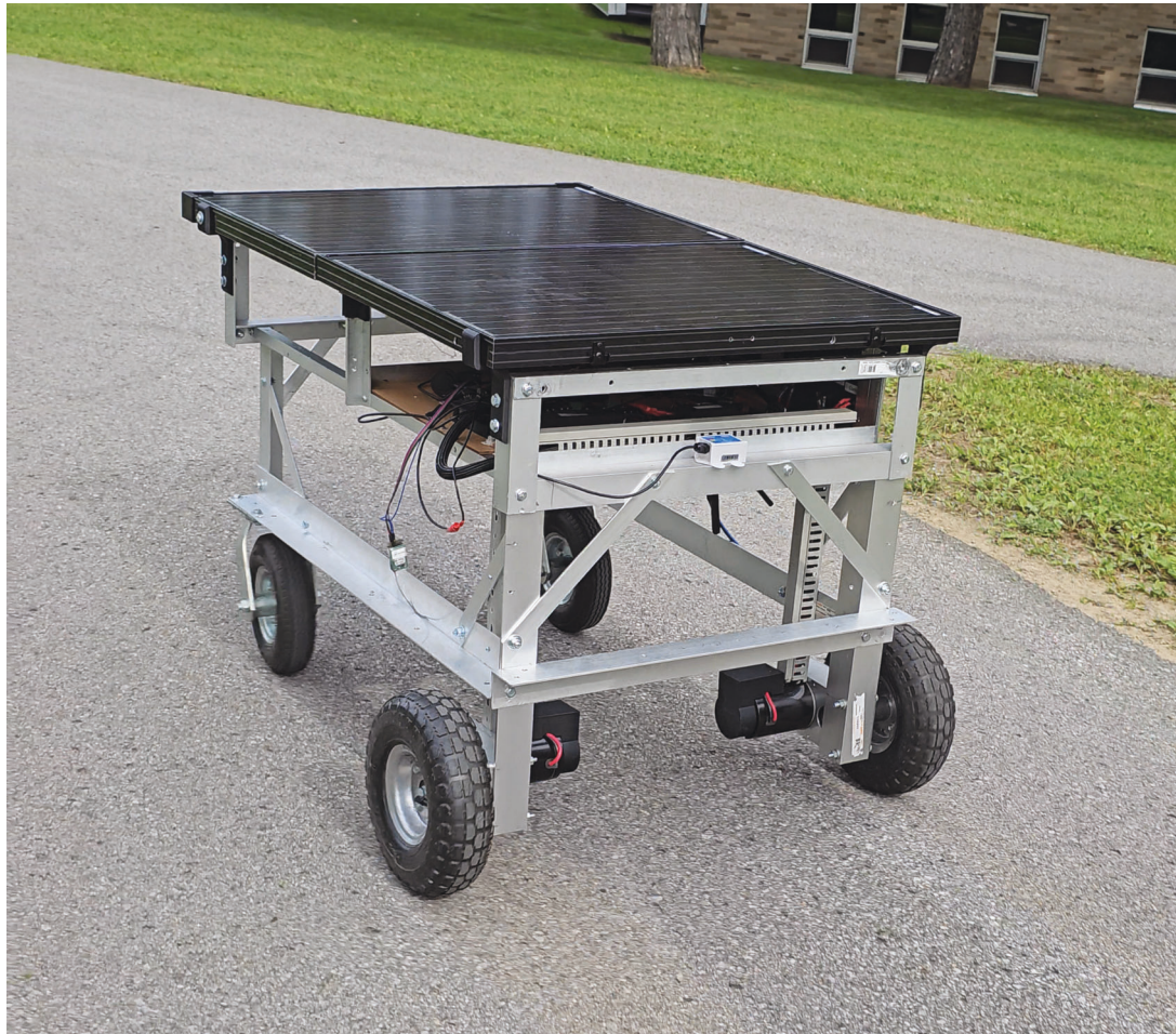
Figure 4.1 Prototype du robot agricole utilisé comme plateforme expérimentale - Groupe de recherche en électronique industrielle, UQTR.
