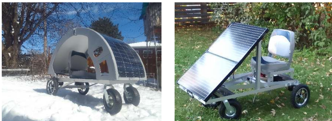
Figure 2.7 Prototypes de VEHBV développés à l'Université du Québec à Trois-Rivières (UQTR).
