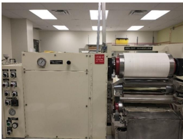
Figure 3.8 Calandre Beloit Wheeler modèle 700 utilisé pour le calandrage.
