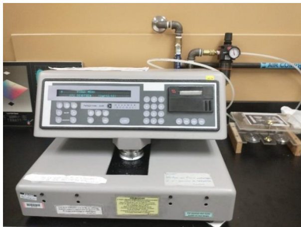
Figure 3.7 Appareil utilisé pour mesurer la perméabilité à l'air.
