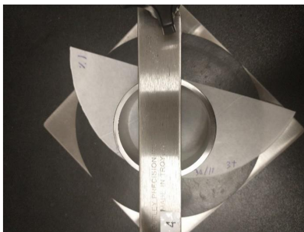
Figure 3.6 Appareil utilisé pour l'indice Cobb.
