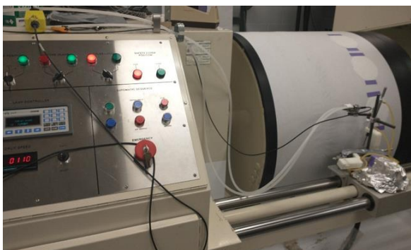
Figure 3.11 Coucheuse de Laboratoire CLC-7000 avec la bande de papier.
