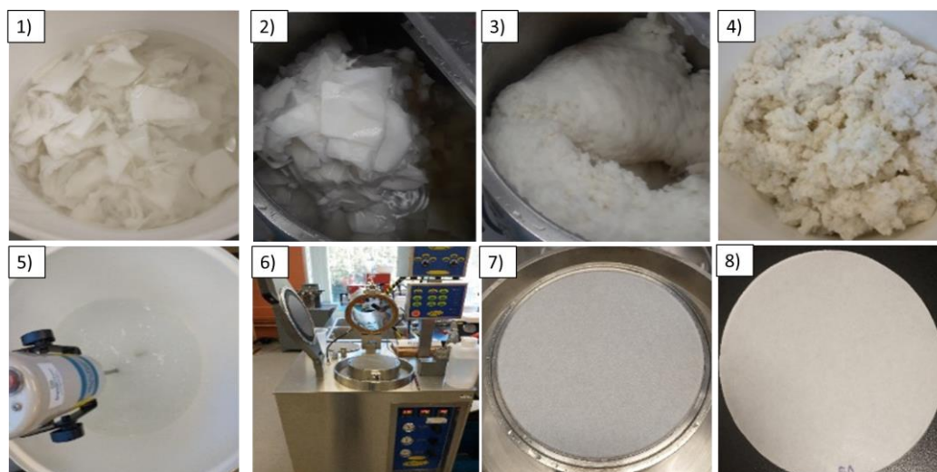
Figure 3.5 Représentation des principales étapes de production des formettes standards : 1) Déchiquetage des papiers, 2) et 3) Trituration, 4) Pâte obtenue, 5) Dilution de la pâte, 6) et 7) Fabrication d'une formette standard, 8) Formette standard sèche.
