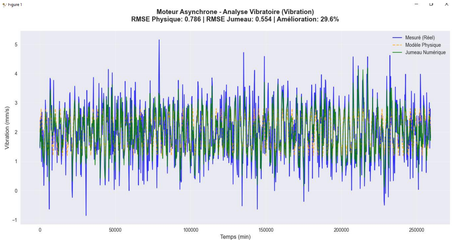
Figure 13 : analyse vibratoire du moteur asynchrone Siemens de 30 kW
