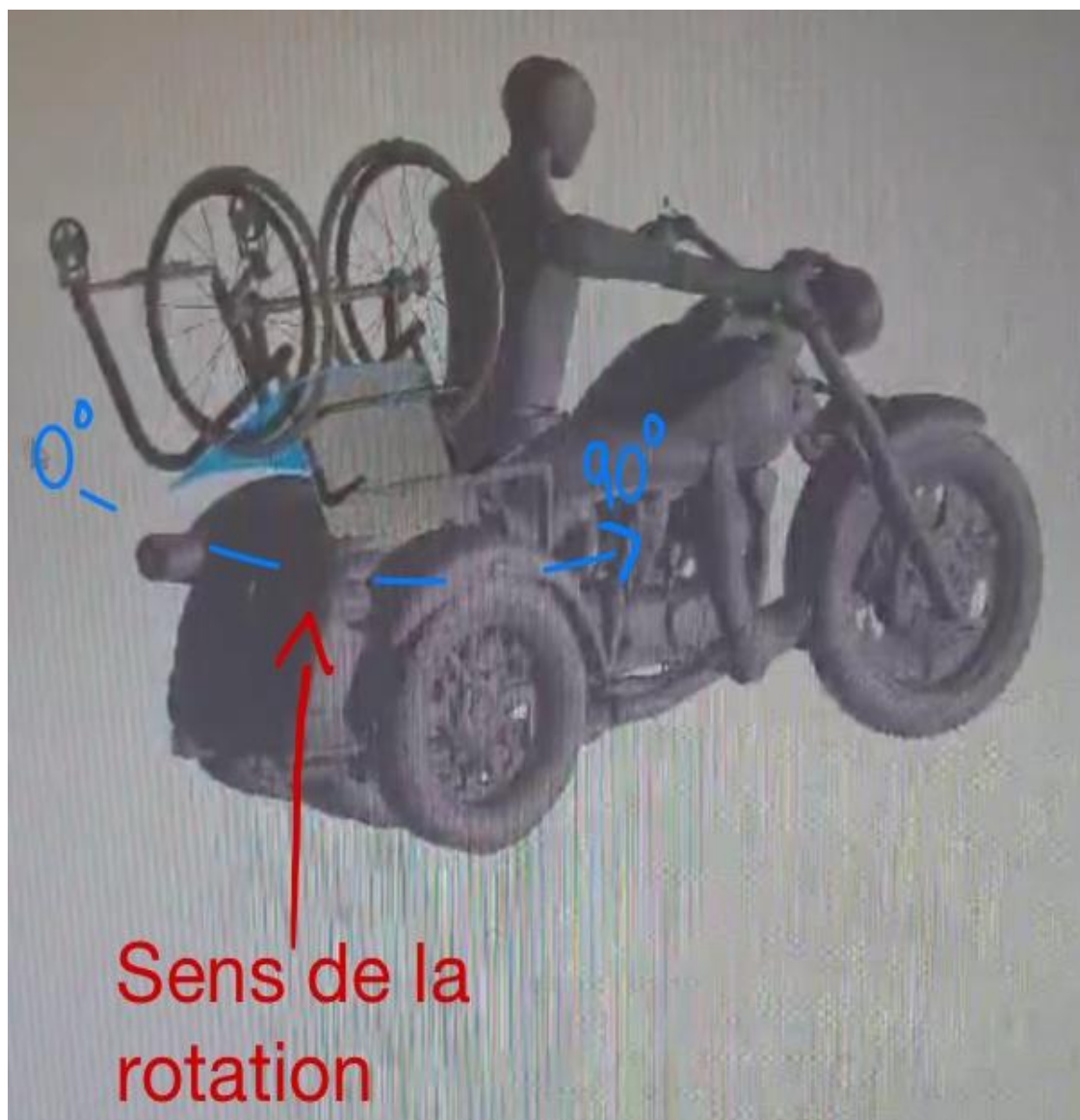
Figure 18 : Motocyclette à trois roues, système d'adaptation et fauteuil roulant vus en angle du côté droit avec identification du sens de la première rotation du fauteuil roulant pour le déchargement (Roy, 2025).
