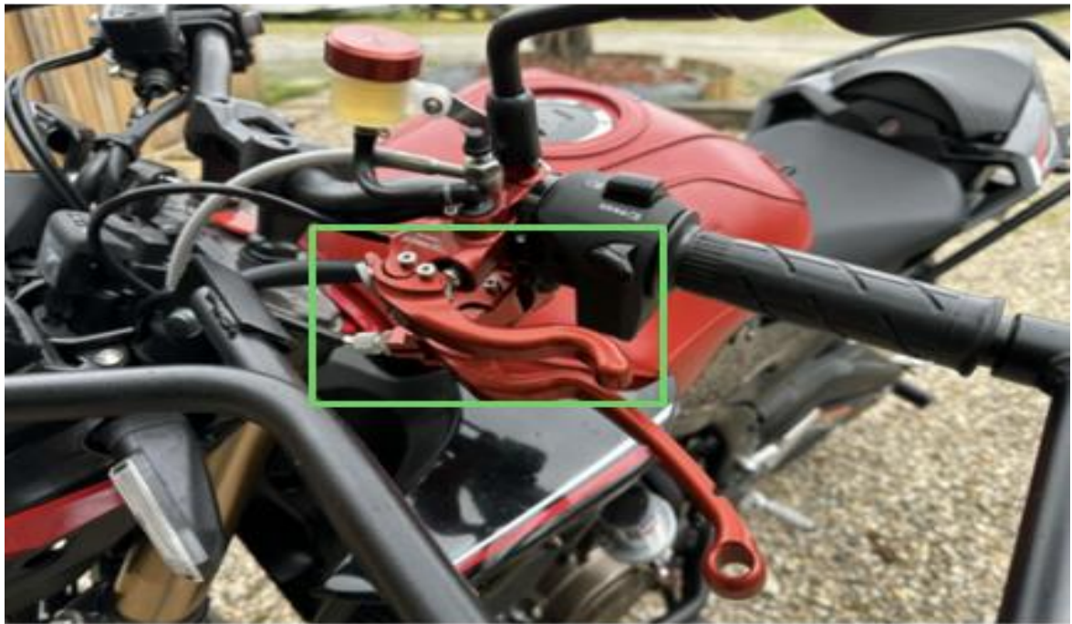
Figure 1 : Déplacement du frein arrière à la poignée gauche du guidon (Futurall, 2021).
