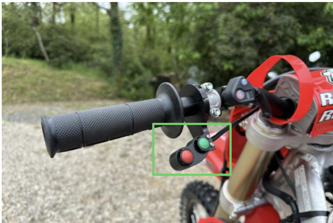
Figure 2 : Déplacement du levier de vitesse à la poignée du guidon gauche (Futurall, 2021).
