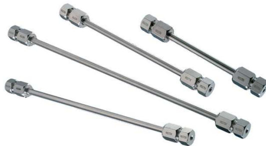
Figure 2.24 Colonnes HPLC contenant le catalyseur
