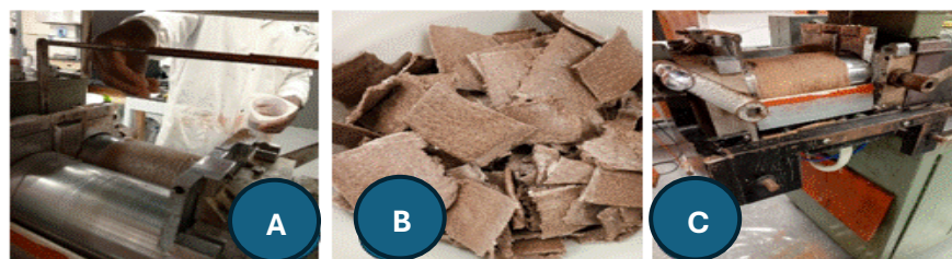
Figure 3.16 Pâtes de composite : A- fusion de PEBD, B- la pâte, C- mélange de pâte
