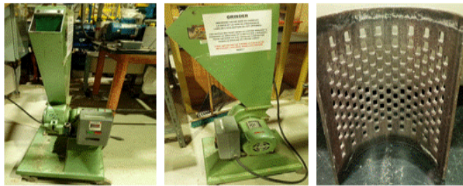
Figure 3.17 La granuleuse H. Drecher Maschinenbau et la maille
