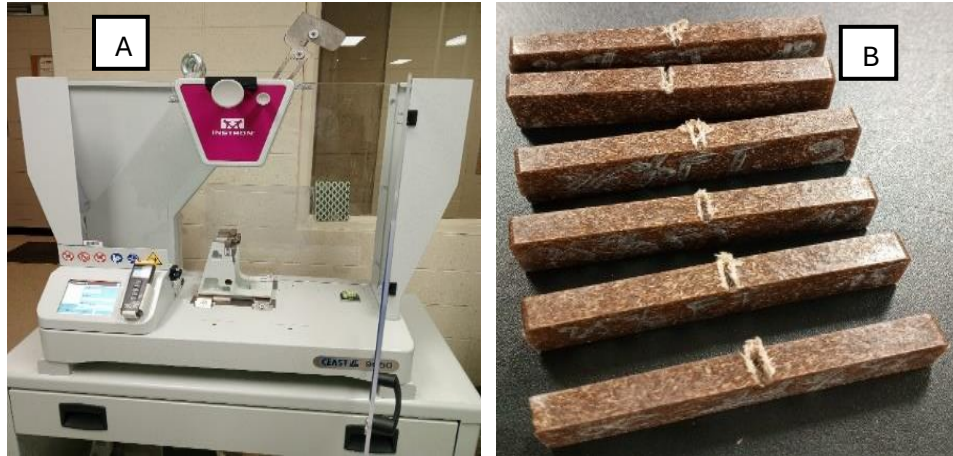
Figure 3.24 A = matériel de mouton pendule; B = éprouvettes taillées en V
