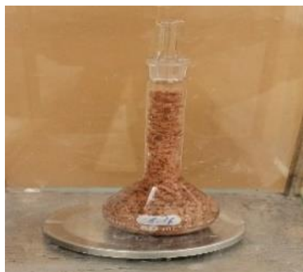
Figure 3.6 Détermination de la masse volumique des fibres et des composites
