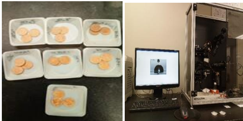
Figure 3.10 Épreuves et essai de détermination d'angle de contact
