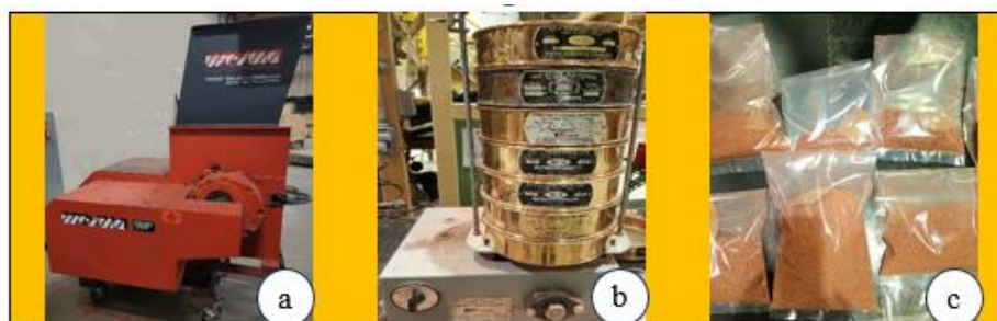
Figure 3.4 a- Broyeur lent Weima type WLK-4 ; b- Système de tamisage, c- Différentes fractions granulométriques
