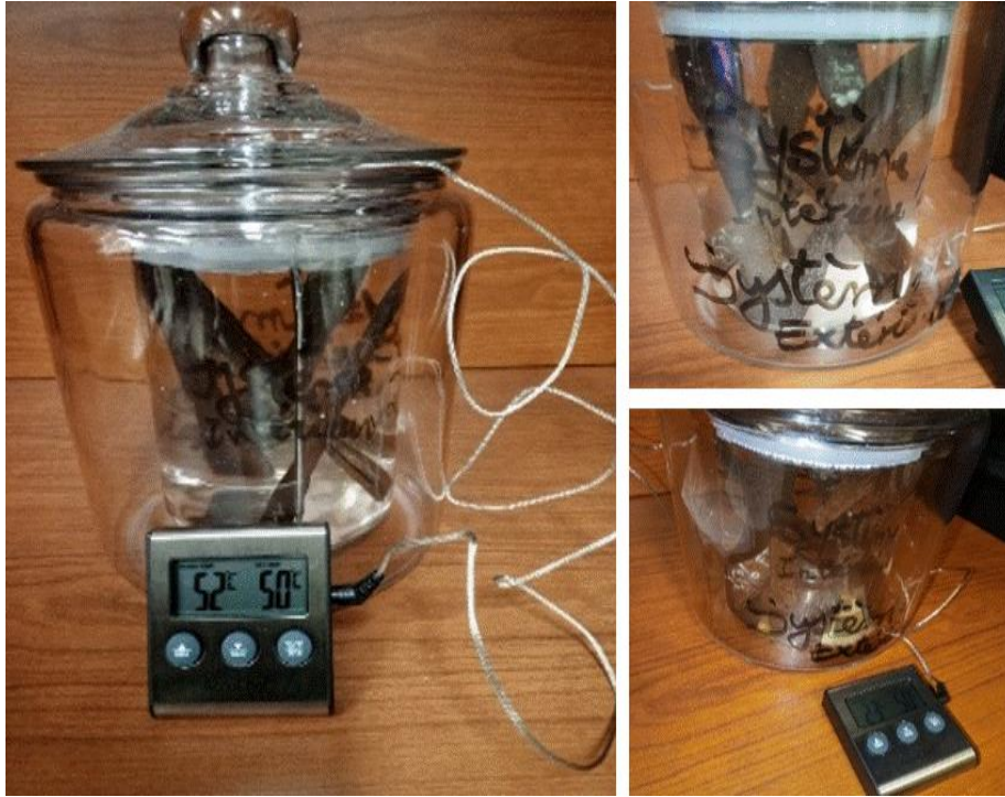
Figure 3.32 b- Système de vieillissement à 23°C; et 50 et 75°C
