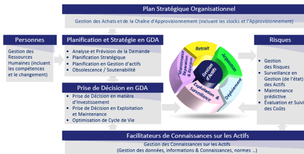
Figure 2-14 : Système de support de la GDA basé sur l'IA (Mattioli et al., 2020)
