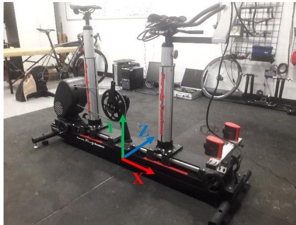
Figure 1 : Orientation des axes de coordonnées globales
