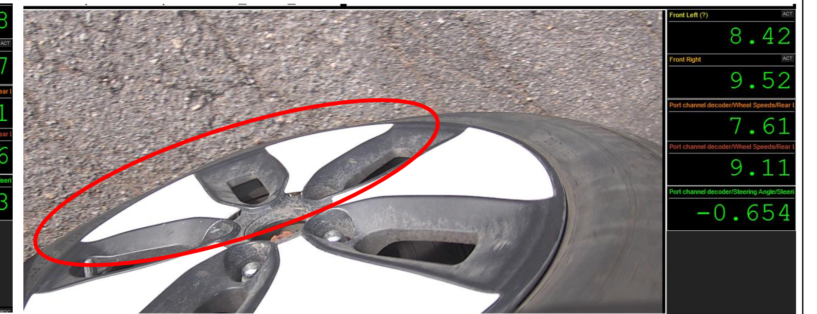
Figure 4: Le pneu à l'instant après le glissement. Notez le flanc du pneu dans l'ovale à la suite de la réduction de l'effort latéral lors de l'interaction entre le pneu et la chaussée.
