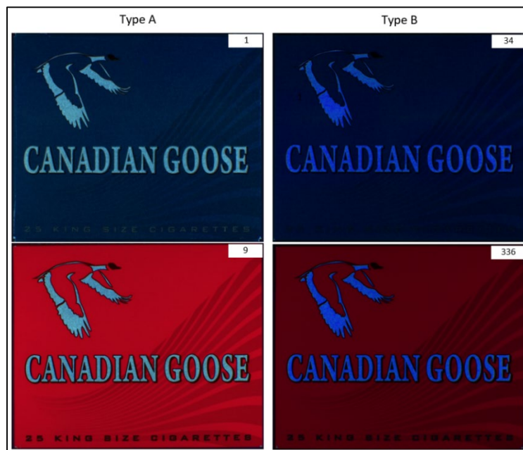
Figure 34. Types de réaction aux rayons UV des paquets de l'ensemble #2
