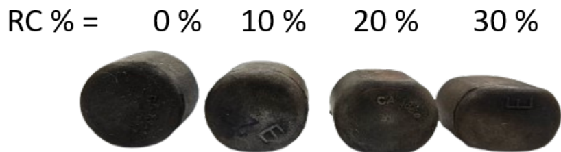
Figure 5.16 Évolution de la déformation permanente en augmentant le taux de compression
