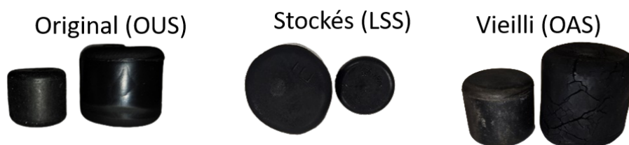
Figure 5.11 Échantillons avant et après les tests de gonflements.
