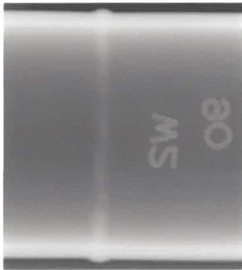
Figure 4.2 : Radiographie d'une conduite présentant une soudure circonférentielle.
