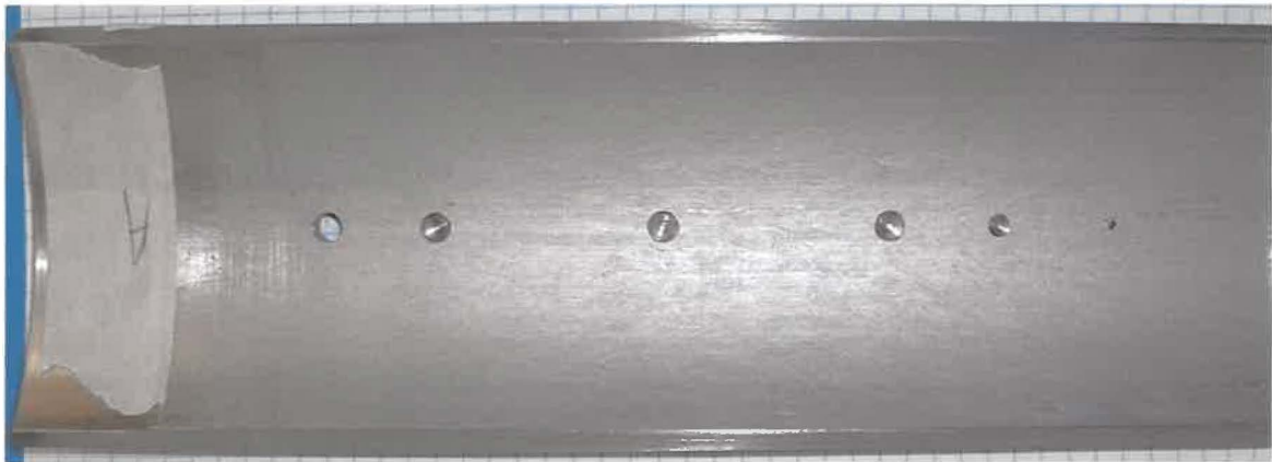
Figure 4.3 : Section de conduite présentant des perforations à fond conique sur la surface interne.
