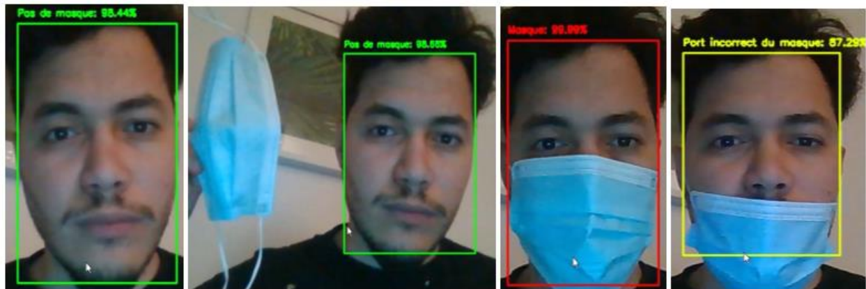
Figure 18 : Test de détections de masque en temps réel
