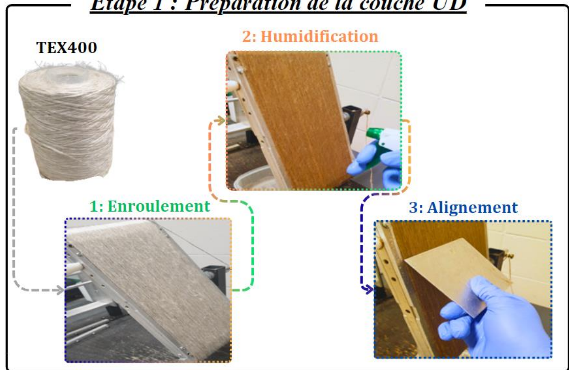
Figure 3.1 : Processus de fabrication de la couche unidirectionnelle (UD) de lin.
