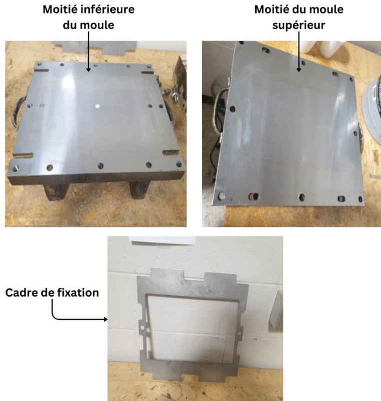
Figure 3.5 : Configuration du moule pour le processus de moulage par transfert de résine (RTM).
