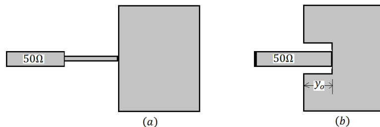
Figure 2.11 Antenne patch micro-ruban avec alimentation latérale
