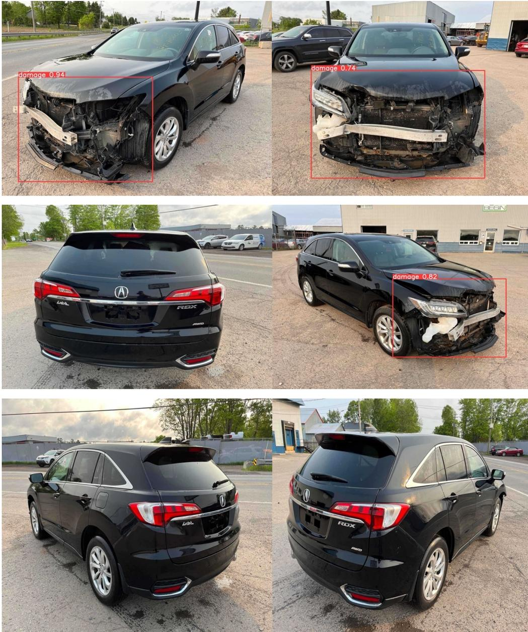
Figure 42 : Détection de dommage sur une voiture à partir de plusieurs angles
