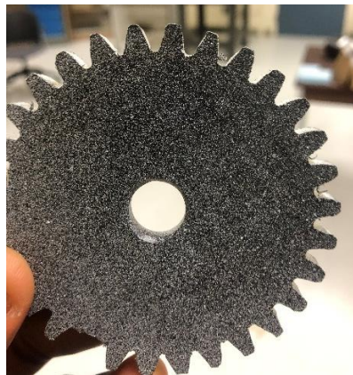
Figure 3.15 : Réalisation du Mouchetis sur les dents d'engrenage
