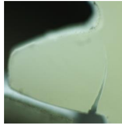
Figure 2.8 : Rupture en flexion par fatigue au pied d'une dent
