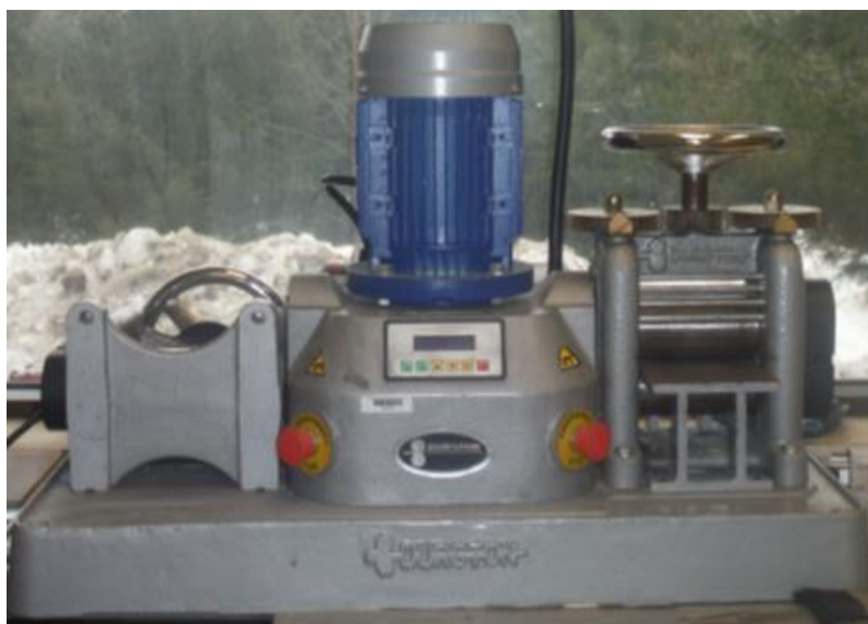
Figure 2.3 Appareil de laminage à froid modifié pour le laminage horizontal (à droite) et vertical (à gauche).
