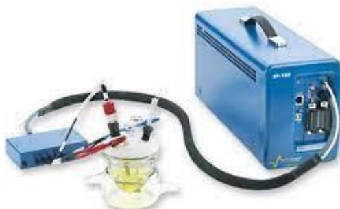
Figure 2.10. Potentiostat SP-50 de BioLogic avec cellule d'électrochimie. 37
