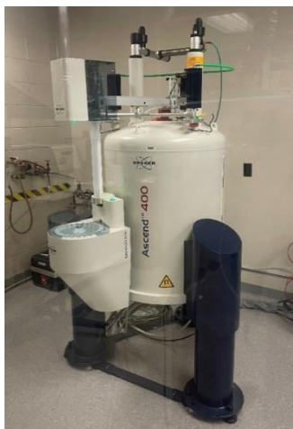
Figure 2.5. Spectromètre RMN Ascend 400 de Bruker. 34
