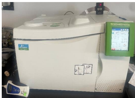
Figure 2.7. Chromatographe (pour chromatographie en phase gazeuse) Clarus 580 de Perkin Elmer.
