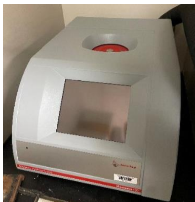
Figure 2.1. Réacteur micro-ondes Monowave 400 de Anton Paar. 30
