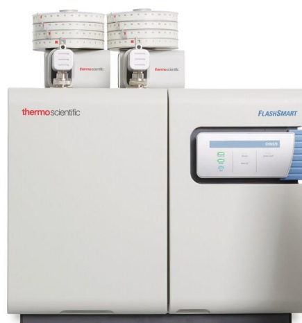
Figure 2.9. Instrument d'analyse élémentaire FlashSmart de Thermo Scientific.
