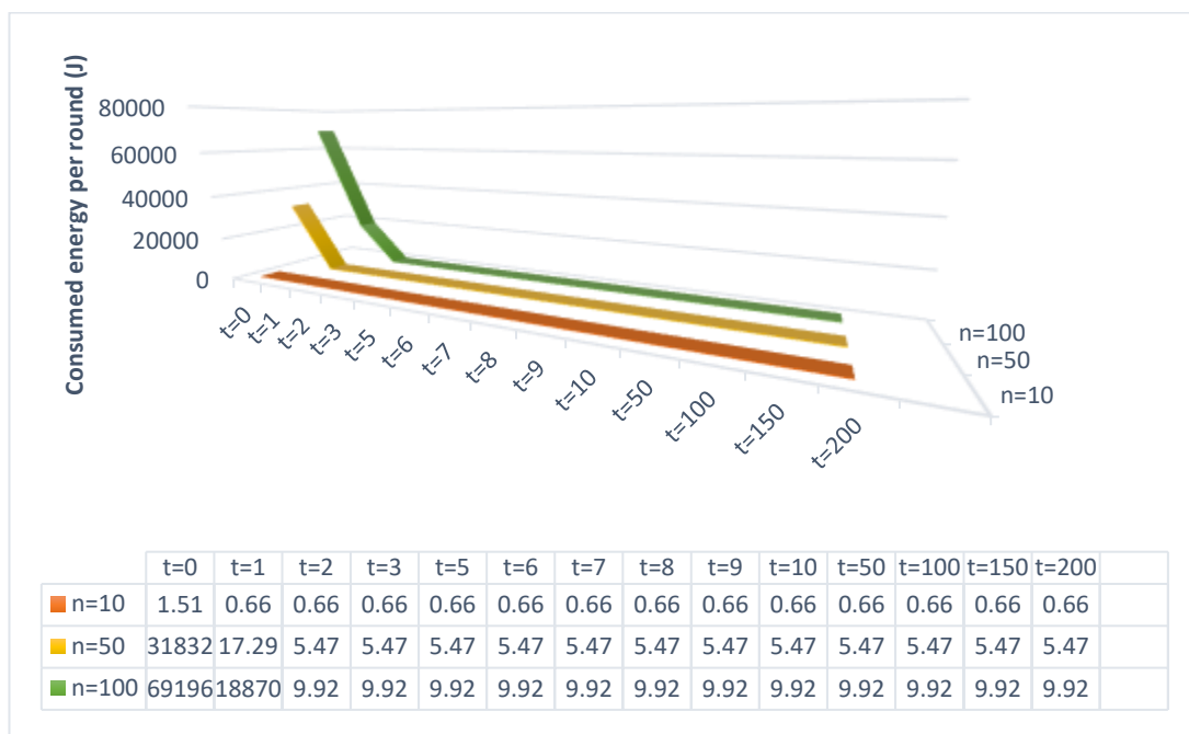
Figure 5.7 Réduction de la consommation d'énergie par le réseau en fonction du nombre d'itérations effectuées par l'algorithme QIC
