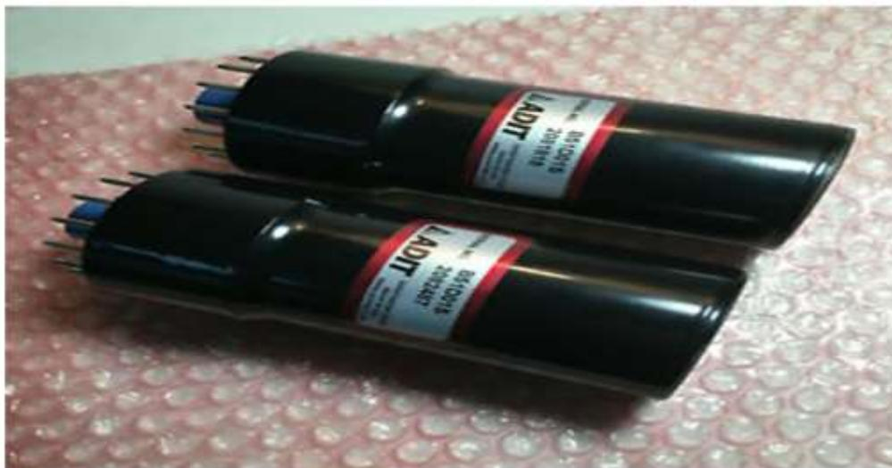
**Figure 3-18:** PMT ADIT\_B51D01 utilisé<sup>5</sup>
