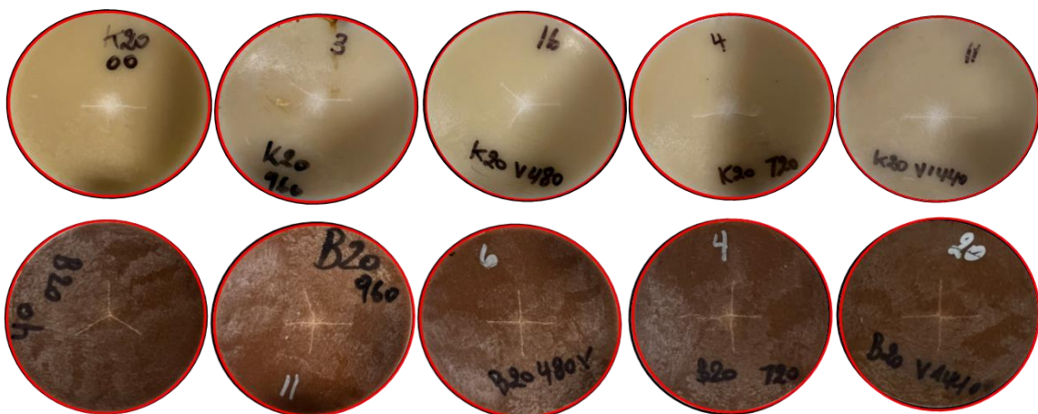
Figure A.43 L'évolution de l'endommagement sur la face arrière des échantillons impactés pour les éprouvettes qui contiennent 20 % des fibres à différents prélèvements (de 0 à 1440 heures)
