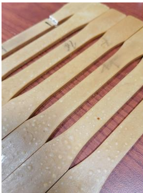
Figure 4.49. Échantillons après exposition, les structures gonflées sont visibles
