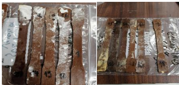
Figure 4.1 Échantillons après exposition à la pourriture blanche à gauche et la pourriture brune à droite.
