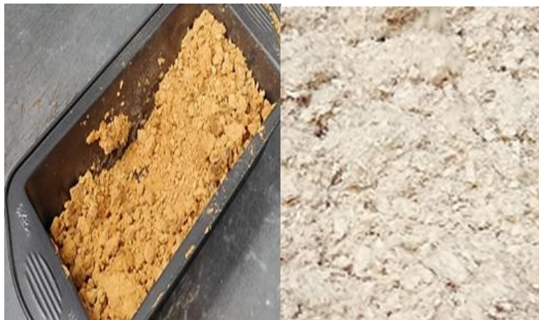
Figure 3.12 Fibres traitées et séchées à gauche et fibres non traitées à droite
