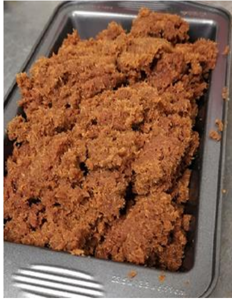
Figure 3.11 Aspect des fibres après absorption de la solution de ZnO- NaOH
