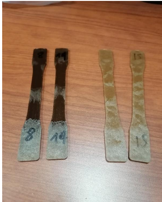
Figure 3.13 Échantillons servant aux essais de traction (20%) non traités au ZnO (2 premiers à gauche) et ceux traités au ZnO (2 derniers à droite)
